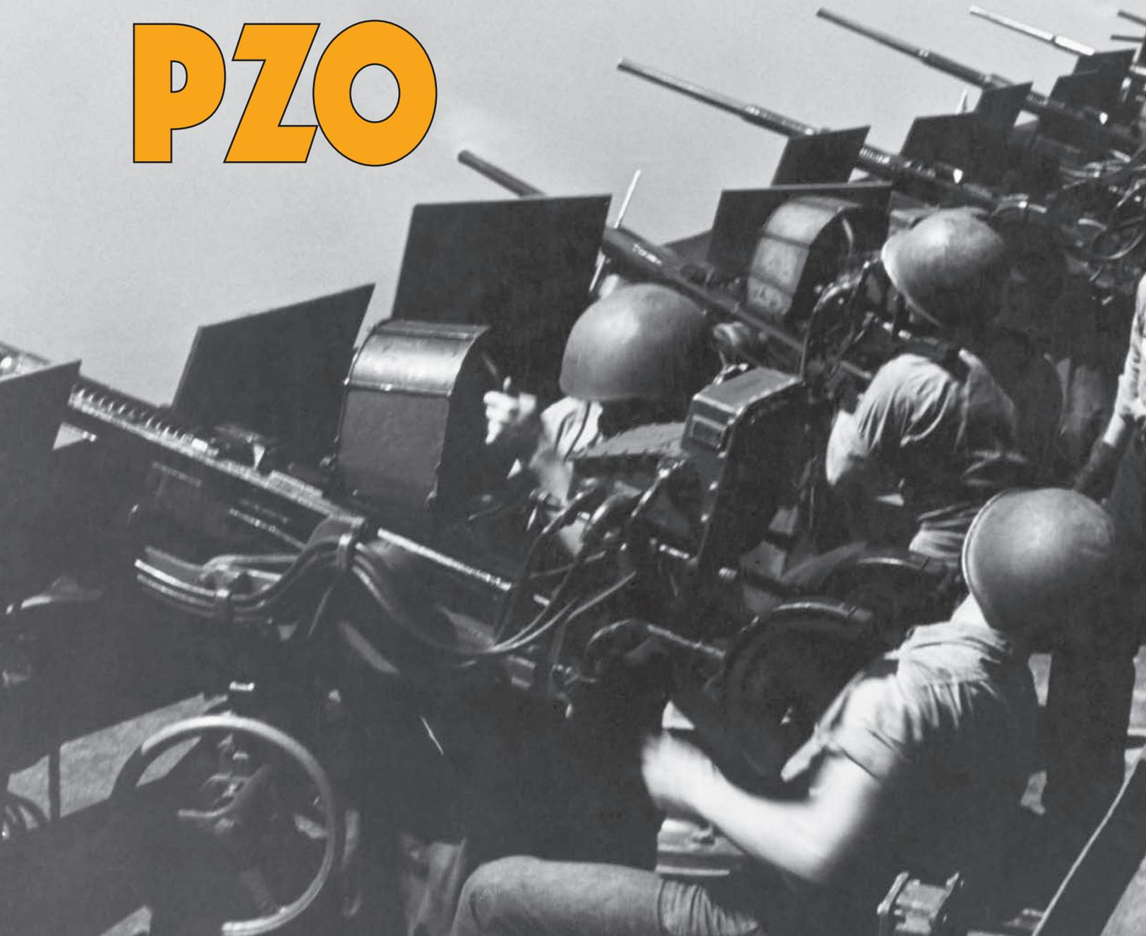
Američki nosač USS Hornet na kraju rata imao je bitnicu od čak 46 topova Oerlikon 20 mm/70 (0.79"). Fotografija je snimljena u veljači 1945. tijekom bombardiranja Tokija
