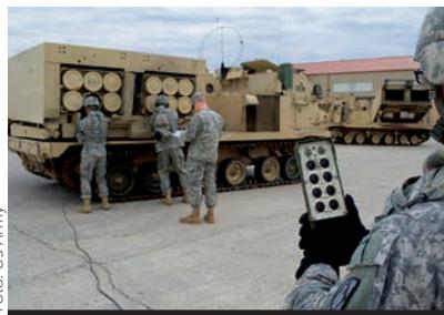
**Kompleti raketa povezuju se kabelima sa SUP-om i nakon toga lansiraju. Precizno poravnanje raketa postiže se i održava mehanički, pri punjenju u lansirni "kavez" sustava**
