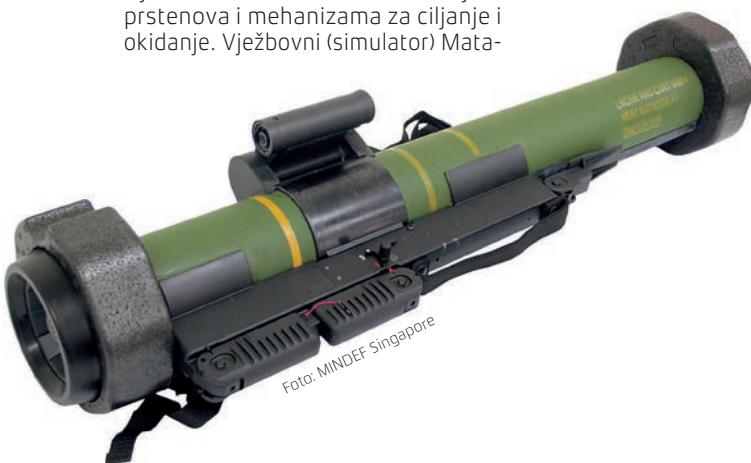
dor za obuku označen je plavim, a borbeni žutim prstenom oko cijevi. Lansirna cijev od ojačanog je fiberglasa, s polimernim učvršćenjima i stiropornim amortizerima. Nekoliko manjih dijelova izrađeno je od čelika. Teleskopski cilnik pricvršćen je na oružje preko Picatinny šine, a dostupan je i nočni cilnik.
