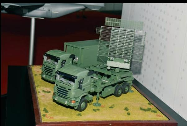
Lockheed Martinov radar TPS-77 MRR dizajniran je za nadzor i identifikaciju niskoletećih objekata na srednjim i velikim udaljenostima
