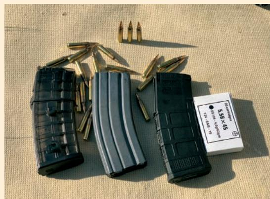
Spremniči koji se mogu rabiti na Hellionu. Slijeva: originalni VHS-2 spremnik (potrebno je zamijeniti uvodnik spremnika na puški), aluminijski AR-15 spremnik i najnoviji Magpulov spremnik za AR-15/M16/M4 standard
