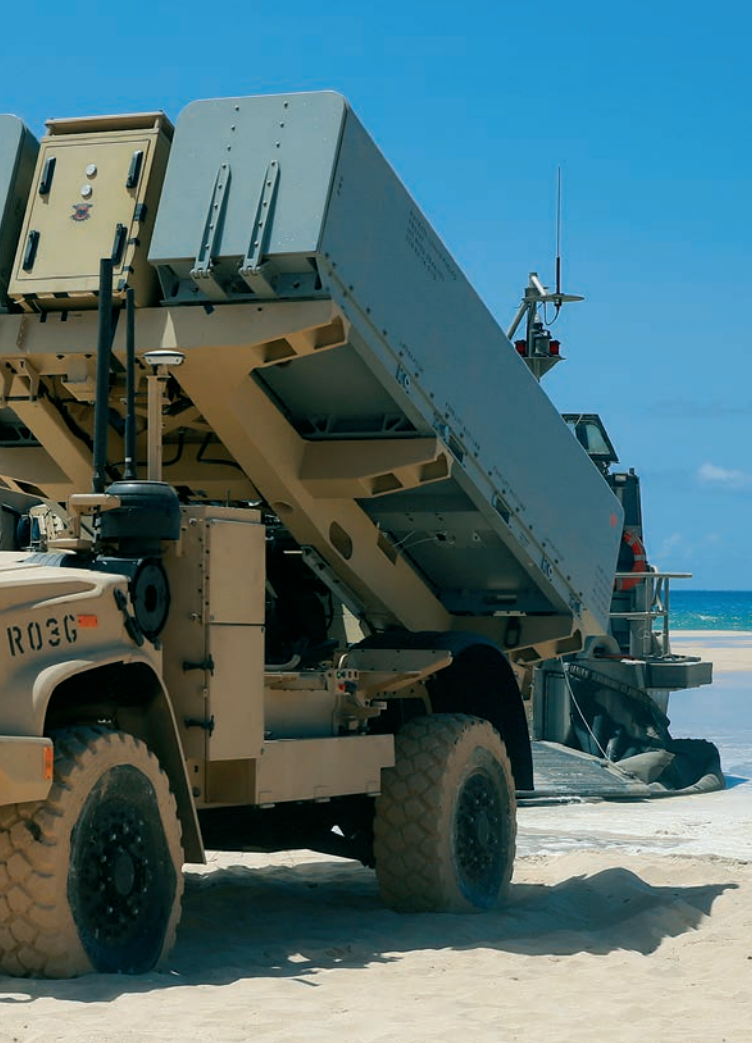
Protubrodski raketni sustav NMESIS: lako oklopno vozilo JLTV s daljinskim upravljanjem i bez kabine koje nosi dvostruki lanser raketa NSM
