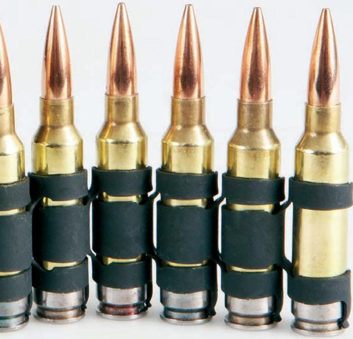
**SIG Sauerovo streljivo 6,8 Fury.** Metak ima čahuru koja se sastoji od dva osnovna dijela – čeličnog dna i mesinganog tijela povezanih aluminijskom spojnicom kao trećim dodatnim dijelom
