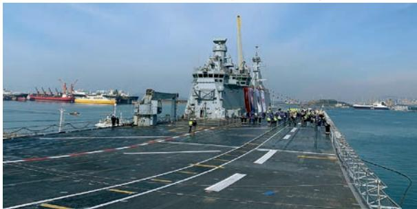
Površina uzletno-sletne palube nosača TCG Anadolu iznosi  $6440 \text{ m}^2$ , a hangara za zrakoplove  $990 \text{ m}^2$
