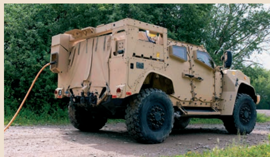
Hibridni eJLTV s priključenim kabelom za punjenje električnom energijom
