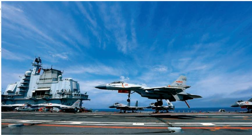
**Višenamjenski borbeni avion J-15 slijeće na Liaoning s izvučenom kukom. Riječ je o inačici prilagođenoj pramčanoj skakaonici čiji je uzor sovjetski avion Su-33**
