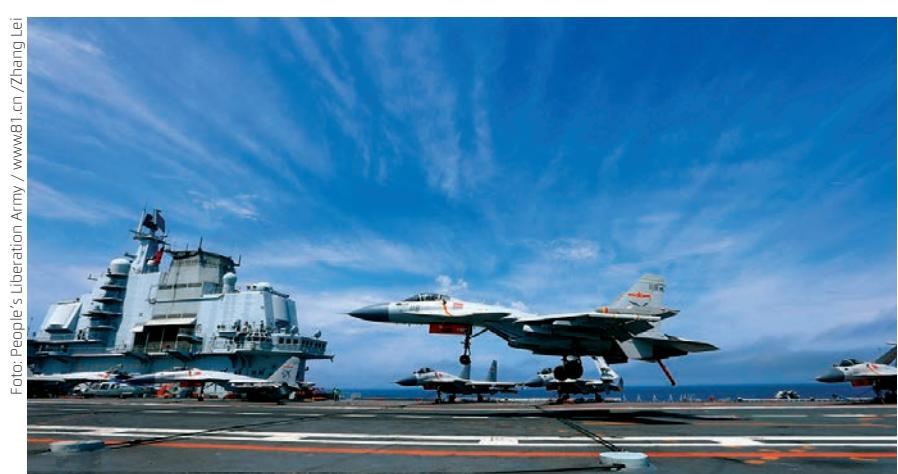
**Višenamjenski borbeni avion J-15 slijeće na Liaoning s izvučenom kukom. Riječ je o inačici prilagođenoj pramčanoj skakaonici čiji je uzor sovjetski avion Su-33**
