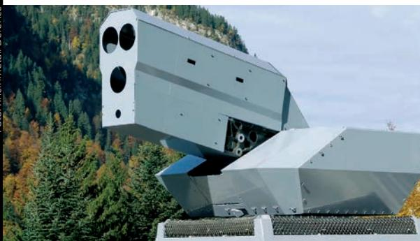
**Rheinmetall je razvio prototip laserskog oružja instaliranog na postolju koje je inače namijenjeno topu Oerlikon Revolver Gun kalibra 35 mm. Sustav ima tri izvora laserskog zračenja**
