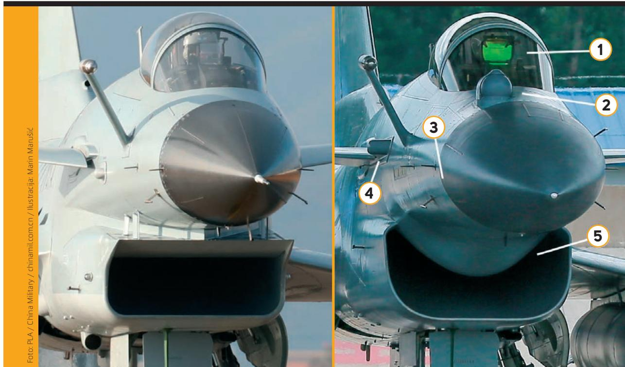
**Razlike između inačice J-10A i aviona J-10 nove generacije uključuju:** novi napredni vjetrobranski hologramski (defrakcijski) prikaznik (1); IRST (InfraRed Search and Track) senzor ispred pilotske kabine (2); veći prednji dio zrakoplova s većom i plosnatijom radarskom kupolom (3); antene sustava električnih protumjera kod korijena kanarda (4); novi (DSI) uvodnik zraka (5)
