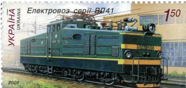
Električna lokomotiva napaja se iz kontaktnog voda ovješena iznad tračnica preko klizača ili iz voda položena na tlo između tračnica
