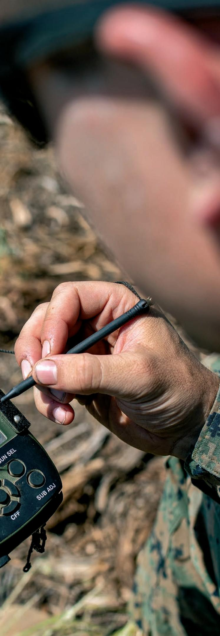
Danas je djelovanje mnogih oružnih sustava, pa i onih nešto manjih, povezano s računalima: na fotografiji je sustav američkih marinaca M32A1 LHMBc (Lightweight Handheld Mortar Ballistic Computer), koji se koristi za gađanje minobacačima M252A1 kalibra 81 mm
