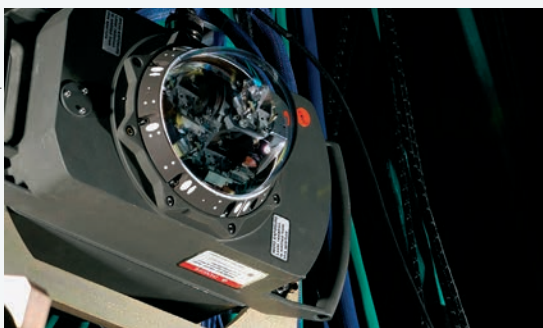
CIRCM – novi sustav za aktivnu obranu od projektila s infracrvenim navođenjem razvila je tvrtka Northrop Grumman
