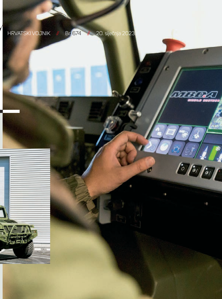
Zapovjedno-nadzorni sustav LIC 2 ORNE dio je sustava Mistral ATLAS RC, koji je isključivo namijenjen za ugradnju na laka terenska vozila (gore)
