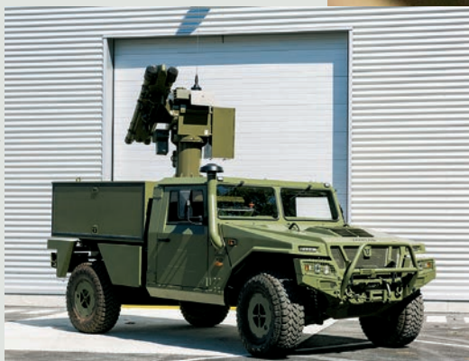
Zapovjedno-nadzorni sustav LIC 2 ORNE dio je sustava Mistral ATLAS RC, koji je isključivo namijenjen za ugradnju na laka terenska vozila (gore)
