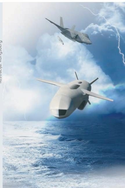
**Projektil JSM (Joint Strike Missile) na ilustraciji norveške tvrtke Kongsberg. Dimenzijsama je prilagođen unutarnjem spremniku za oružje na avionu F-35 Lightning II, ali predviđena je njegova uporaba na vanjskim nosačima oružja**
