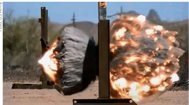
Fotografija djelovanja reprogramibilnog višenamjenskog streljiva (AMP) XM1147. Glavni top testnog Abramsa pogodio je betonski zid
