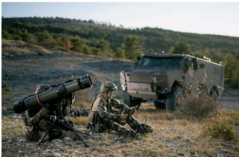
**Uz projektil Akeron MP ide i lanser koji se sastoji od dnevne i infracrvene kamere, laserskog daljinomjera, GPS sustava i magnetskog kompasa**
