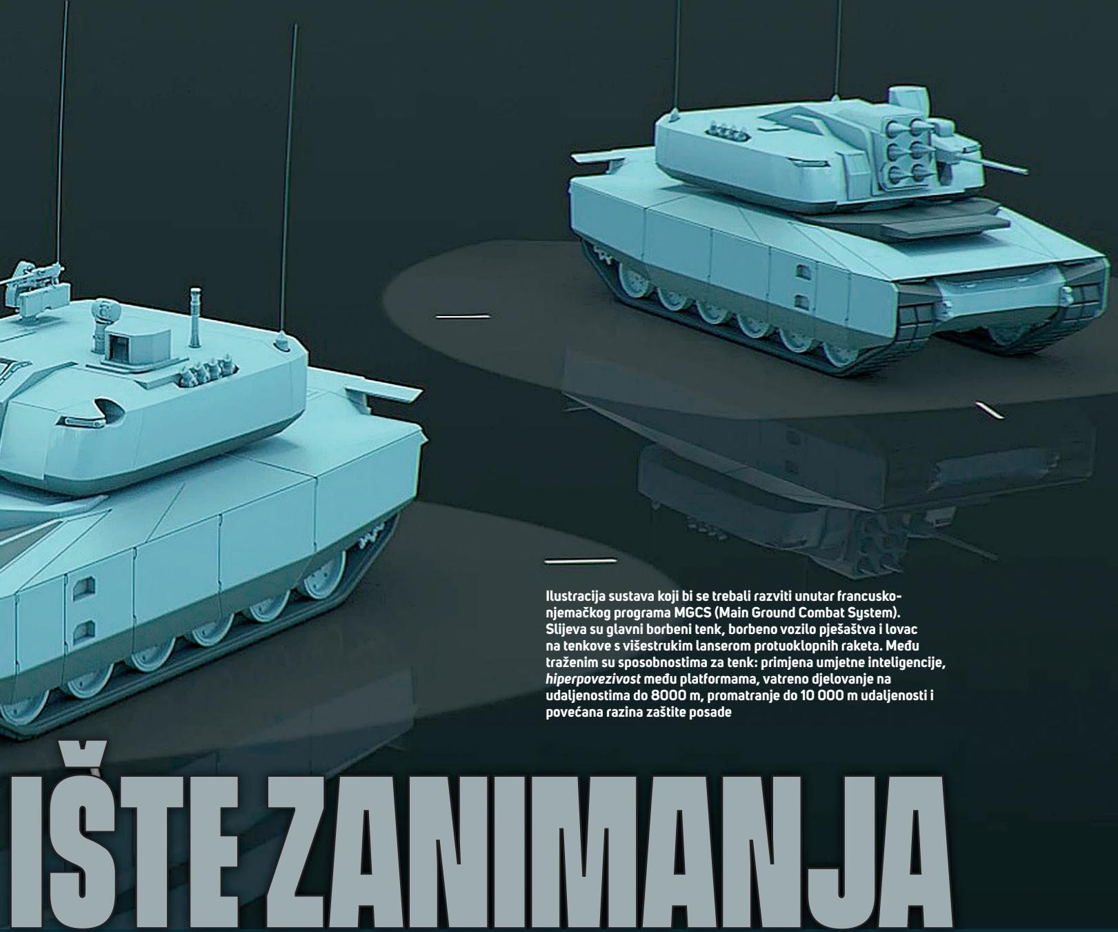
Ilustracija sustava koji bi se trebali razviti unutar francusko-njemačkog programa MGCS (Main Ground Combat System). Slijeva su glavni borbeni tenk, borbeno vozilo pješaštva i lovac na tenkove s višestrukim lanserom protuoklopnih raketa. Među traženim su sposobnostima za tenk: primjena umjetne inteligencije, hiperpovezivost među platformama, vatreno djelovanje na udaljenostima do 8000 m, promatranje do 10 000 m udaljenosti i povećana razina zaštite posade
