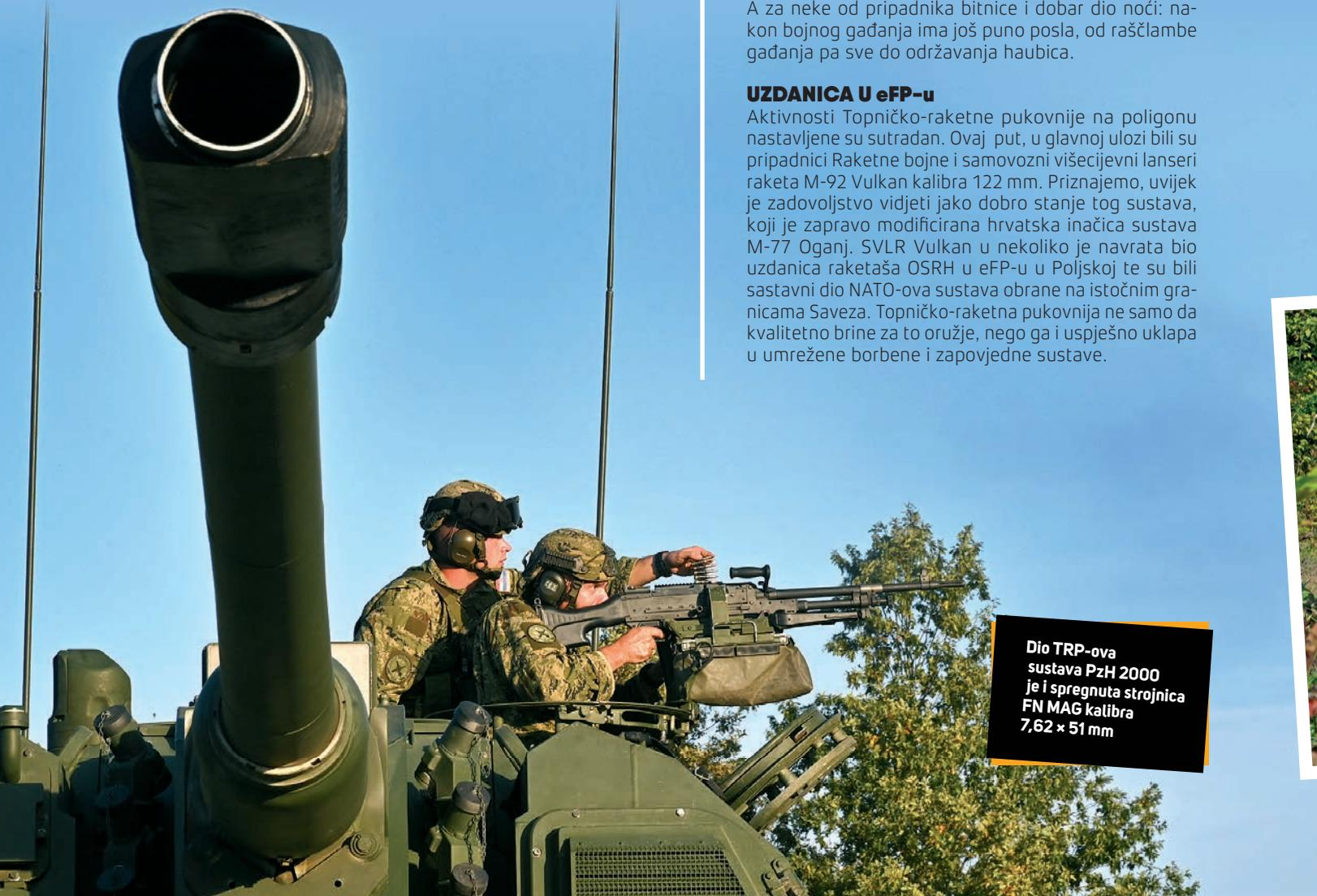
Dio TRP-ova sustava PzH 2000 je i spregnuti strojnica FN MAG kalibra 7,62 x 51 mm
