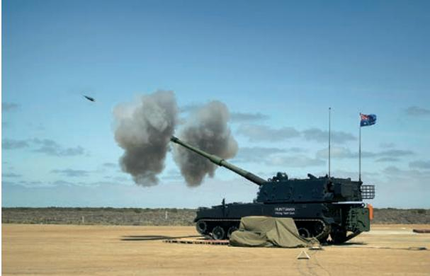
**Demonstracija gađanja australske inačice, haubice AS9 Huntsman, na poligonu Port Wakefield 21. rujna 2023. Sustav će imati poboljšanu oklopnu zaštitu te pojačan ovjes, pa se prepostavlja da će borbeni masa AS9 biti oko 50 tona**
