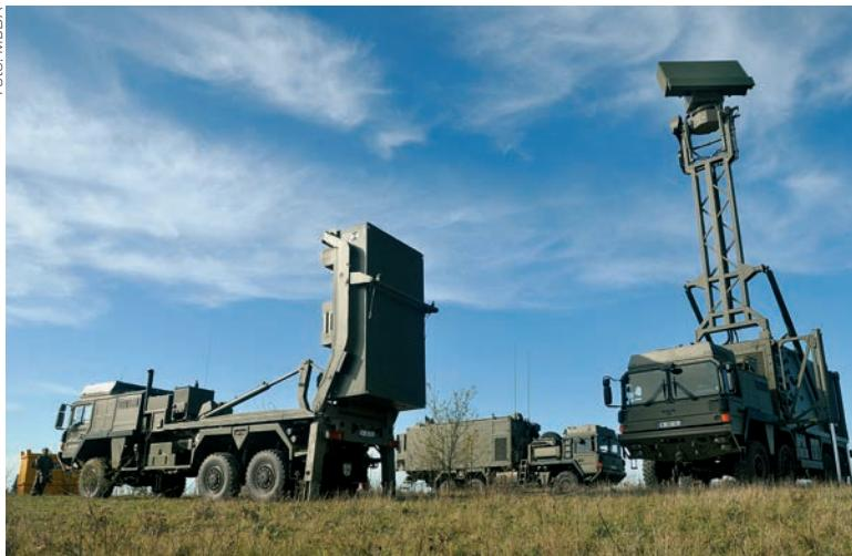
Jedna od konfiguracija sustava VL MICA tvrtke MBDA. Bitnica se u osnovi sastoji od tri do šest lansera instaliranih na terenskim kamionima
