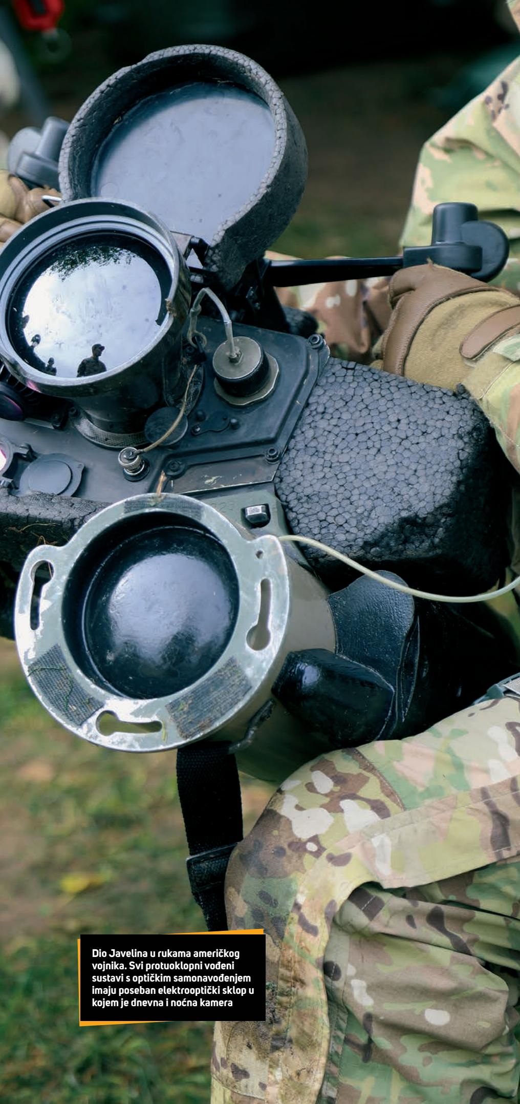
Dio Javelina u rukama američkog vojnika. Svi protuoklopni vođeni sustavi s optičkim samonavodenjem imaju poseban elektrooptički sklop u kojem je dnevna i noćna kamera
