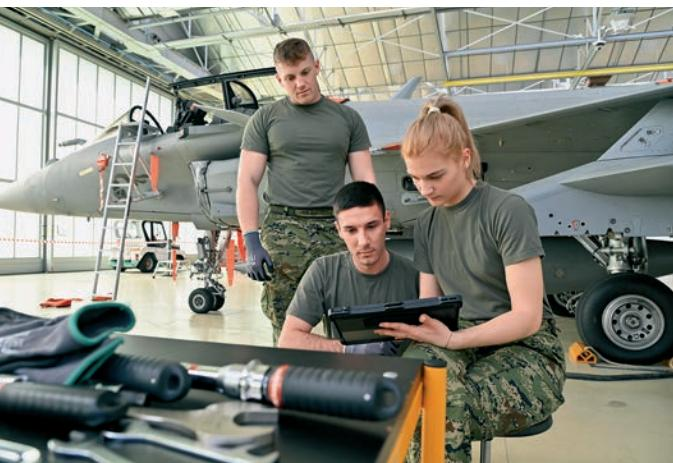
Na zaslonu tableta ili računaču prikazani su svi podaci o održavanju aviona ili potrebi za promjenom nekih dijelova na njemu što je iznimno tehnički skok u odnosu na dosadašnji način održavanja borbenih aviona
