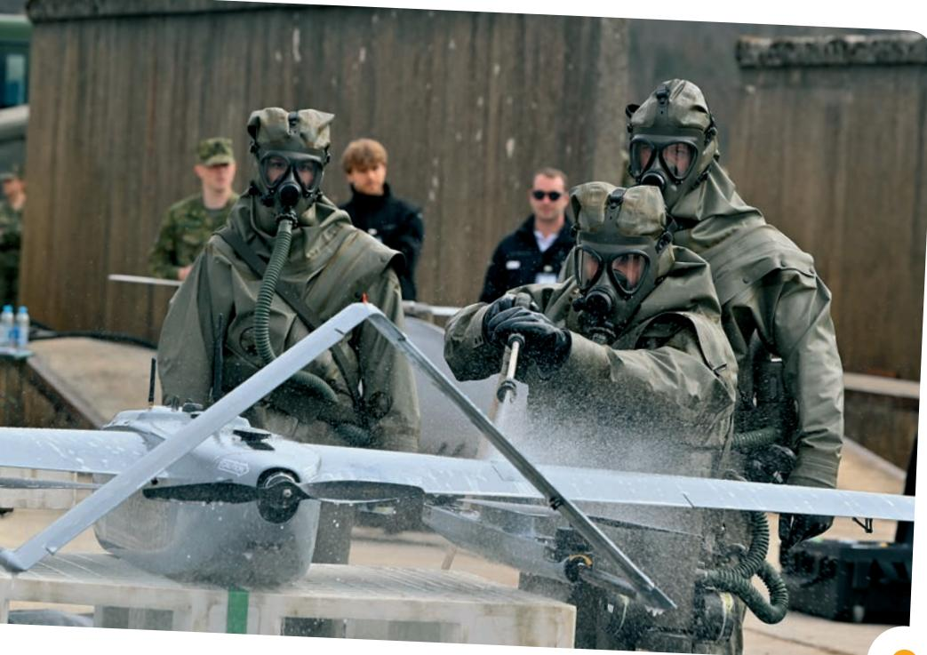
**Letjelica je morala proći kroz dekontaminaciju za koju se pobrinuo adekvatno opremljen i osposobljen vod za RBK dekontaminaciju iz Bojne NBKO**
