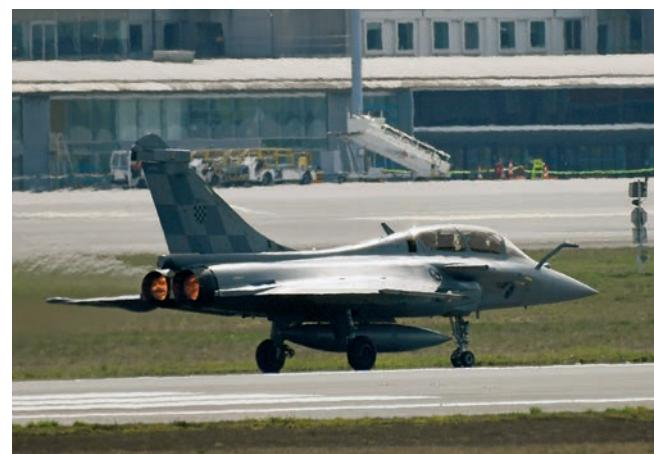
Potrebna duljina polijetanja aviona Rafale ovisi o poletnoj masi odnosno konfiguraciji aviona i kreće se oko 600 m
