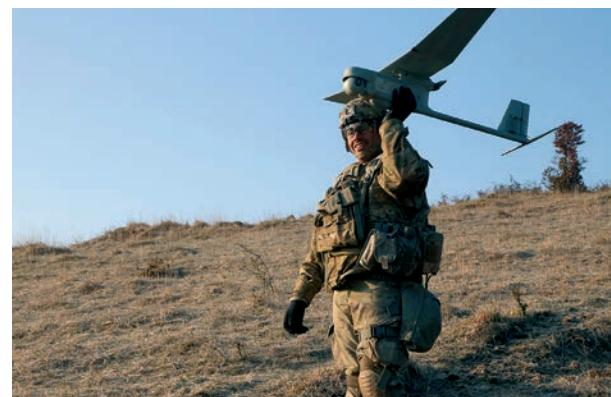
**Američki vojnik s letjelicom RQ-11 Raven. Dug 91 centimetar, s rasponom krila čak 1,37 m, te brzinom krstarenja od samo 30 km/h, i taj izvidnički dron imao bi probleme nad suvremenim bojištem**
