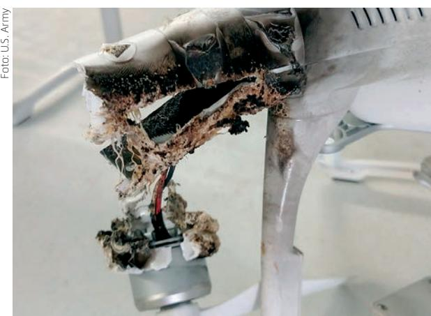
Detalj malog drona (lijevo gore) koji je oborila zraka američkog laserskog sustava MEHEL instaliranog na oklopnom vozilu Stryker (lijevo dolje) na testiranju u vojarni Fort Sill u travnju 2017. Uskoro bi se trebali pojaviti i prvi operativni sustavi koji će protiv dronova koristiti lasersku zraku
