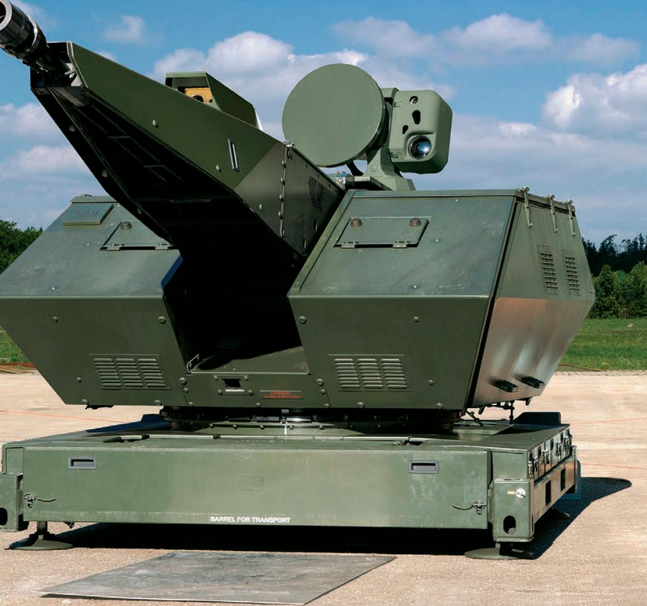
Oerlikon Revolver Gun Mk3 kalibra 35 mm udarna je snaga Rheinmetallova topničkog PZO sustava Skynex. Kako bi se povećala učinkovitost protiv vrlo malih ciljeva koji lete na malim i vrlo malim visinama, svaki top dobio je ciljnički radar i elektrooptički ciljnički sustav
