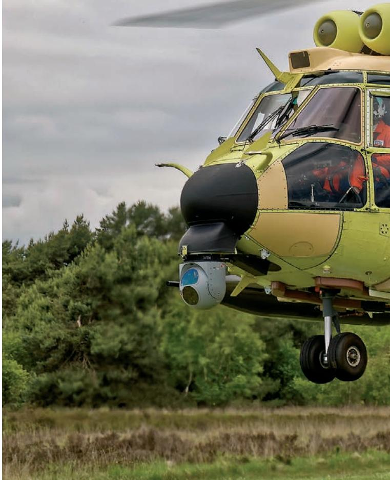
može raditi 30 minuta. Održavanje je olakšano modularnim dizajnom pogonske skupine i prikupljanjem informacija koje se dobivaju preko instaliranog dijagnostičkog sustava HUMS (Health and Usage Monitoring System). Proizvođač tvrdi da letjelica pokazuje operativnu raspoloživost veću od 95 %. Ima mogućnost ugradnje dodatnog agregata (Auxiliary Power Unit – APU) koji olakšava djelovanje s neuređenih i izdvojenih uzletno-sletnih lokacija.
