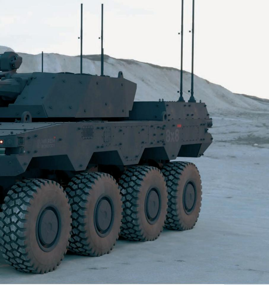
Milremovo borbeno vozilo HAVOC na kotačima u konfiguraciji 8 x 8. Opremljeno je topom kalibra 30 mm, a na cesti postiže maksimalnu brzinu od 110 km/h
