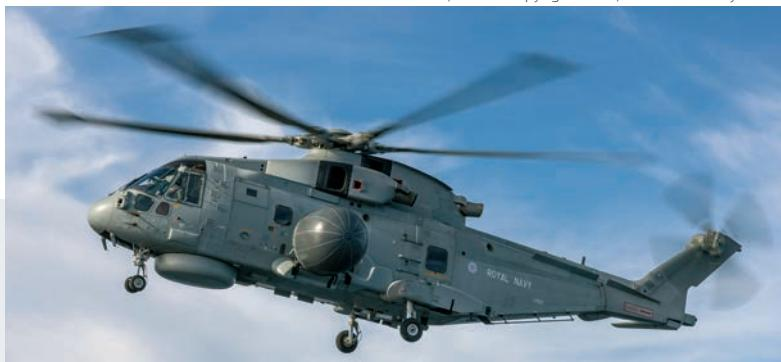
**Leteći radar Merlin Crowsnest u službi britanske Kraljevske ratne mornarice: motrenje se ostvaruje s pomoću rotirajuće antene smještene u kućištu (radom) koje se napuhuje, pa na lijevom boku helikoptera izgleda poput balona**
