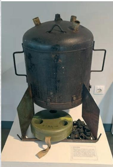
**Bojler-bomba kolokvijalni je naziv za improvizirane zrakoplovne bombe koje su 1991. godine izrađivali i koristili pripadnici Samostalnog zrakoplovnog voda Osijek. Sastojale su se od bojlera ili velike plinske boce sa četirima upaljačima na prednjem dijelu te zavarenim krilcima na stražnjem dijelu. Bile su napunjene protutenkovskim minama i blokovima eksploziva**
