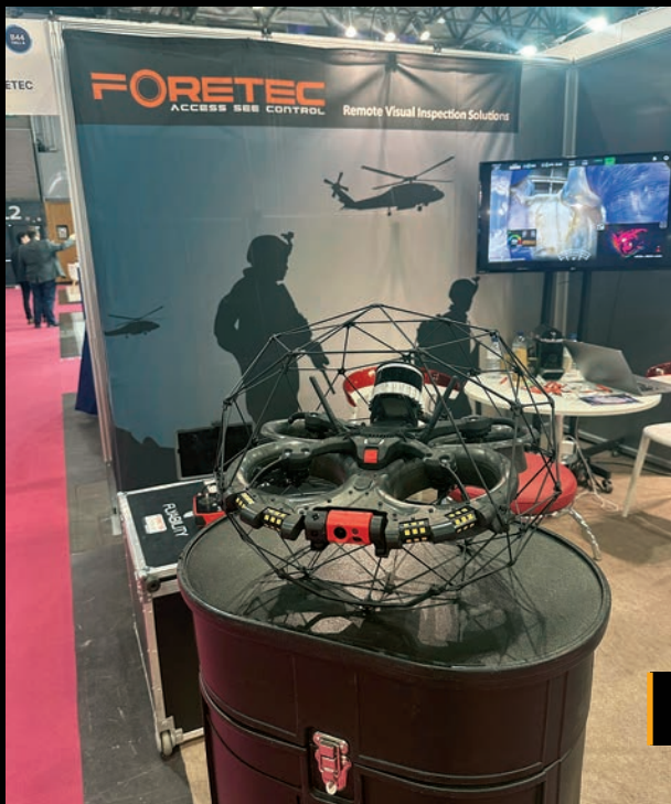
Foretecov dron u kavezu otporan je na udarce u zatvorenim i skućenim prostorima
