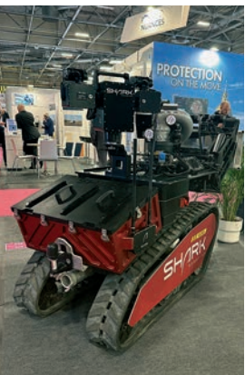
Platforma Colossus može raditi i do 12 sati, prelaziti ruševine, stube i druge zahtjevne zapreke
