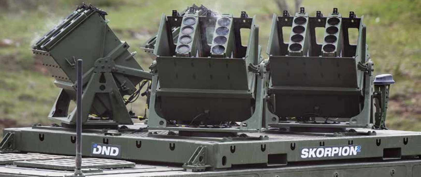
Ono što prvo upada u oči na Komodu jest postolje s četiri lansirna sustava (sijačke jedinice) mina – svaki lanser ima pet spremnika kapaciteta dvadeset mina
