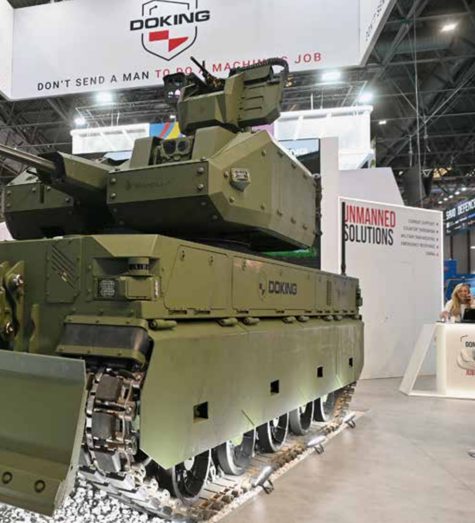
Na štandu DOK-ING-a isticao se Komodo opremljen borbenom stanicom Mangart 30 slovenske tvrtke Valhalla Turrets s topom MK44S Bushmaster kalibra 30 x 173 mm
