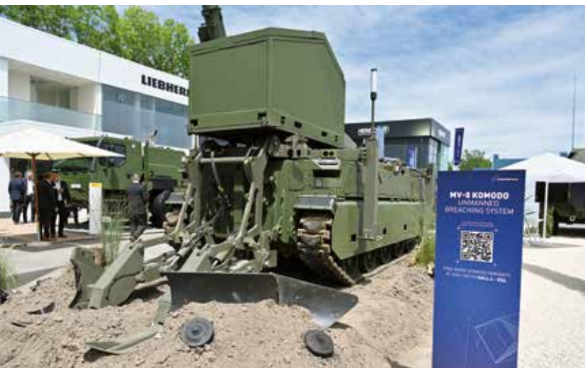
Na štandu DOK-ING-ova njemačkog partnera Rheinmetalla, Komodo je izložen u konfiguraciji za brzi proboj ( breaching ) minskih polja sa sustavom britanske tvrtke Pearson Engineering
