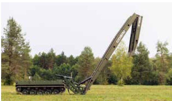
Kad se most rasklapa s pomoću lansirnog sustava instaliranog na prednjem dijelu Komoda te dođe na najvišu visinsku točku, stvarno djeluje poput divovske kobre
