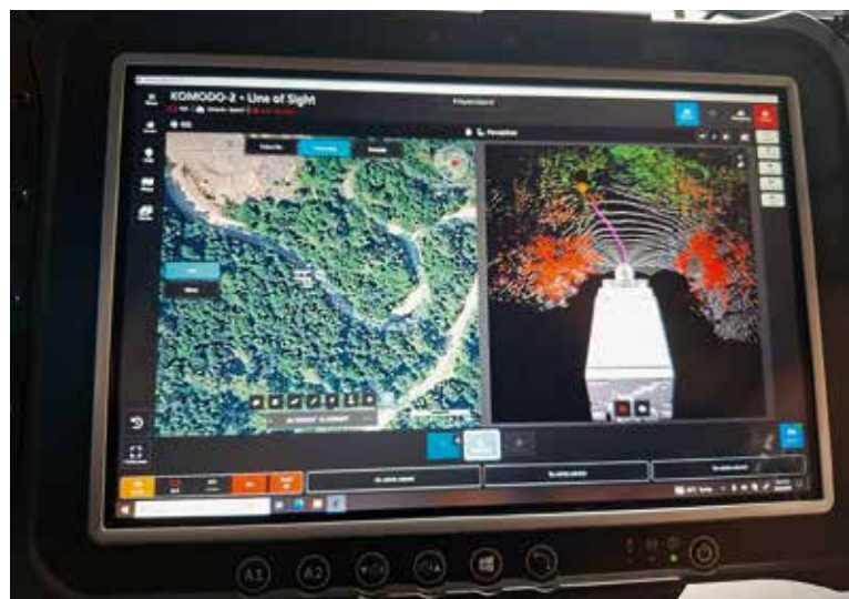
Detalj s testiranja hardversko-sofverskog paketa PATH A-Kit, koji Komodu omogućava autonomno kretanje područjem zadaće ili operacije: nadzor strojnog vida tijekom praćenja konvoja u šumi
