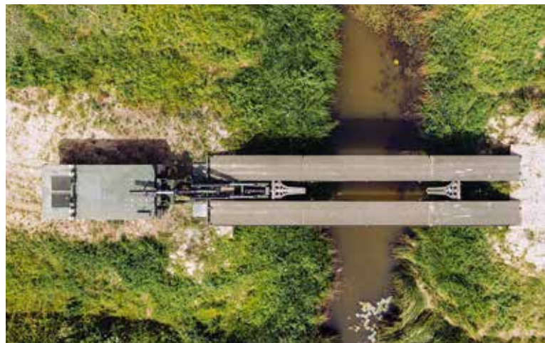
MLC 90 zapravo nije oznaka modela, nego navod da most ima vojnu klasifikaciju opterećenja prema kojoj ga može prelaziti vozilo na gusjenicama mase do 81,7 tona ili vozilo na kotačima mase do 93,9 tona
