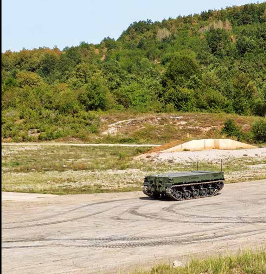
Komodo ponavlja unaprijed definiranu putanju na testiranju sustava PATH A-Kit
