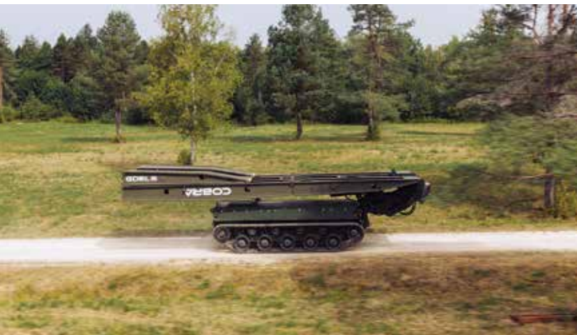
Sa sklopljenom Cobrom MLC 90 na vrhu podvozja, visina osnovne siluete Komoda od 170 cm na najvišoj se točki otprilike udvostručuje, baš kao i ukupna duljina (bazno vozilo dugo je 5,53 m)
